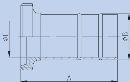
SCHLAUCH GEWINDESTUTZEN ROHR DIN 11851
