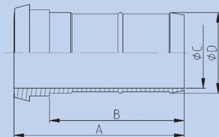
SCHLAUCH KEGELSTUTZEN TYPE DIN, DIN 11851
