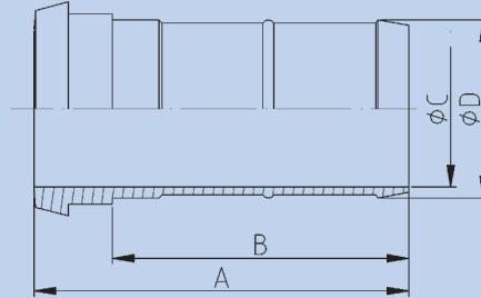
SCHLAUCH KEGELSTUTZEN TYPE BIER DIN 11851
