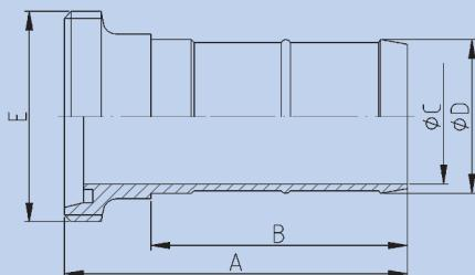
SCHLAUCH GEWINDESTUTZEN TYPE BIER DIN 11851
