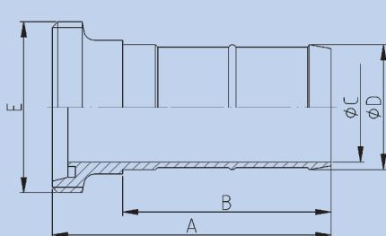
SCHLAUCH GEWINDESTUTZEN TYPE DIN, DIN 11851
