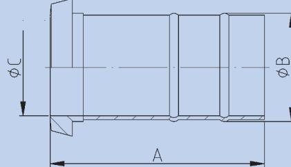
SCHLAUCH KEGELSTUTZEN ROHR DIN 11851
